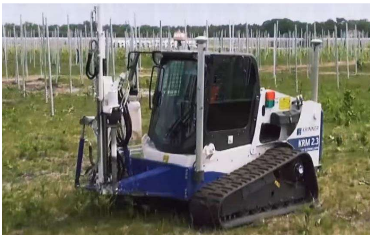
Figura 16 Esempio fissaggio delle strutture di supporto
